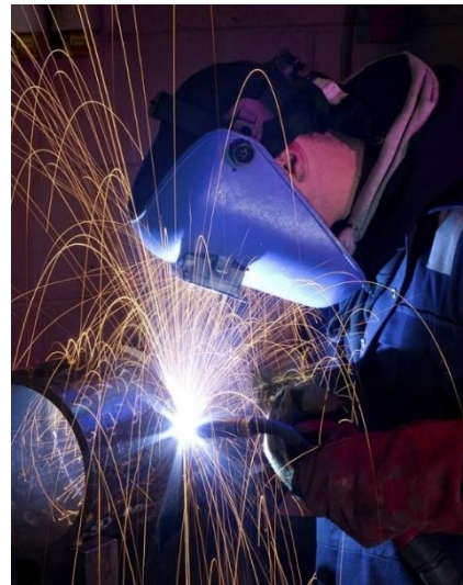
Figur 4 – Partikelprojektion under GMAW svejsning.
