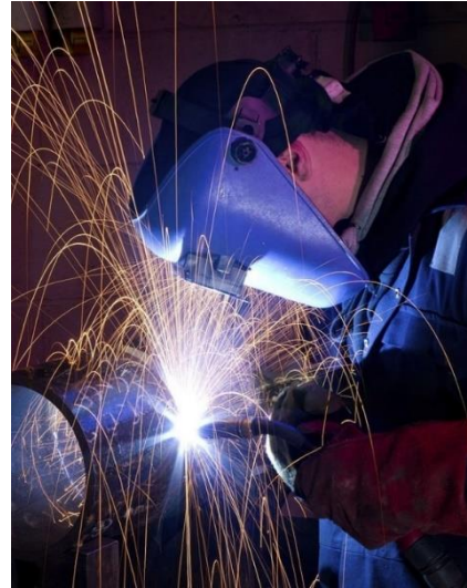
Εικόνα 4 - Προβολή σωματιδίων κατά τη συγκόλληση GMAW.
