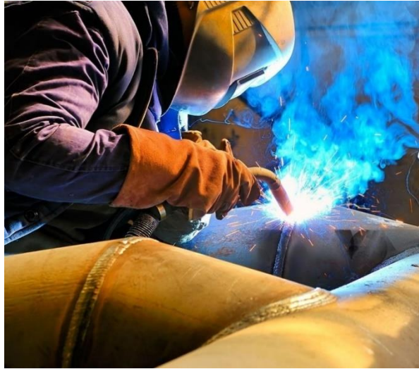
Εικόνα 2 - Καπνοί και αέρια κατά τη συγκόλληση.
